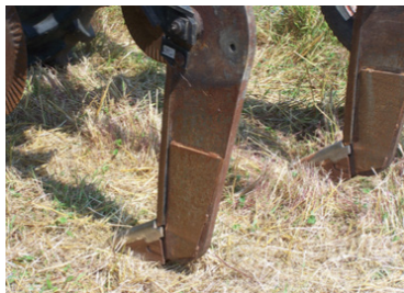
Sous-soleuse à dents droites sans ailette pouvant travailler jusqu'à 70 cm de profondeur
