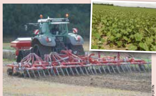
« Avec la trémie avant, je ne surcharge pas la machine qui travaille toujours à la même profondeur et sans contraintes, indique M. Fortin. Comme les résultats sont bluffants avec les couverts et les céréales à l'automne, j'ai même osé semer une partie de mes tournesols en direct avec le Vibro-Seeder. »
