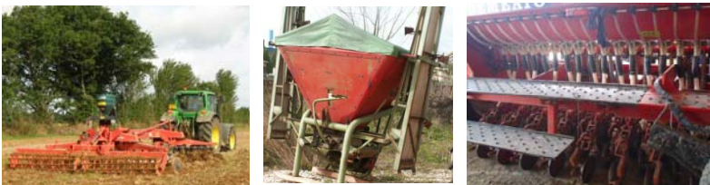
De gauche à droite : distributeur de granulés anti-limaces monté sur un cover-crop pour semer à la volée des petites graines lors du déchaumage, épandeur pneumatique (DP 12) pour le semis « à la volée », outil de semis direct pour un semis plus soigné.
